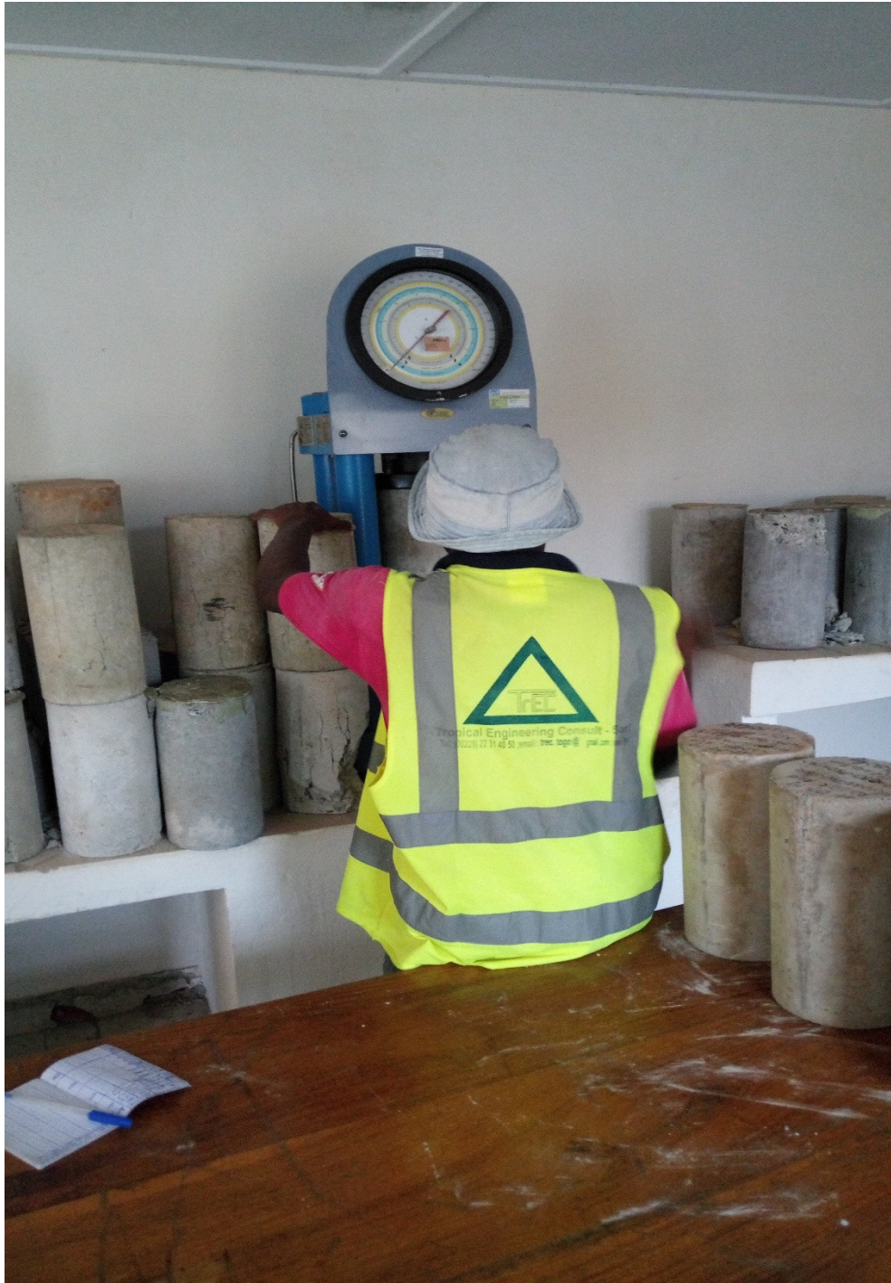
Ecrasement d'éprouvettes de béton
