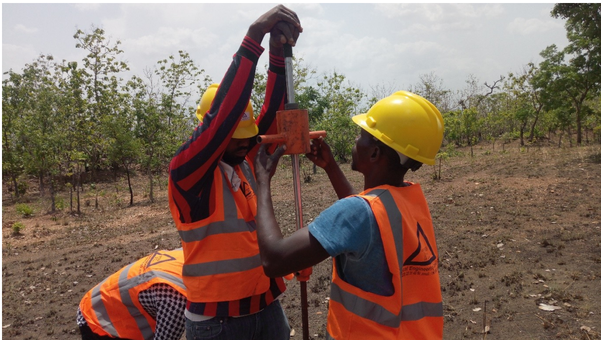
Sondages pénétrométriques sur le site de construction de l'usine de fabrication de bouteilles de gaz de Blitta (Togo)
