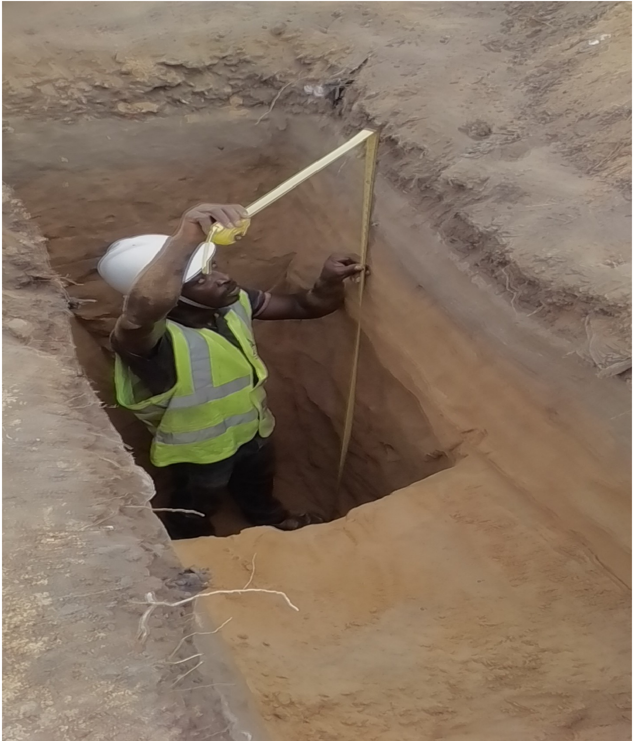
Etablissement d'une coupe stratigraphique sur le site de construction de la nouvelle parfumerie Ghandour dans la zone industrielle de Lomé (Togo)
