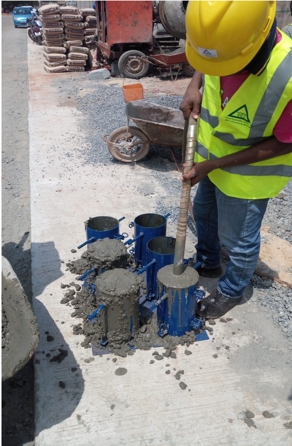
Prélèvements de béton sur le chantier de la Cité renaissance Lomé (Togo)
